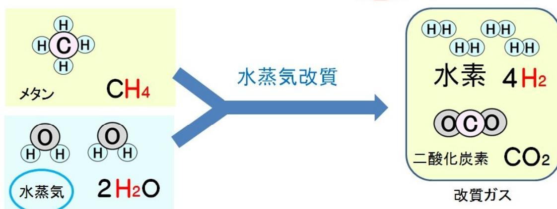
水蒸気改質は、炭化水素や石炭から水蒸気を用いて水素を製造する方法です。
